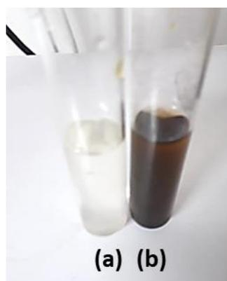
**Figura 11.** Efeito da adição do molibdato em mistura de iodato e periodato: (a) experimento com molibdato e (b) sem molibdato
