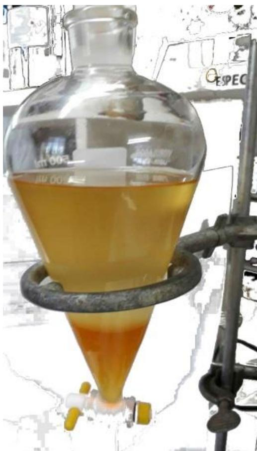
**Figura 8.** Separação das fases do glicerol (mais densa) e do biodiesel (menos densa) após transesterificação do óleo de soja
