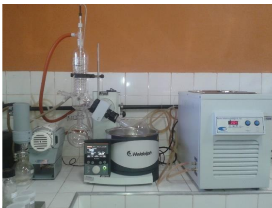
Figura 26. Aparelho evaporador rotativo (Laboratório de Plantas Medicinais e Aromáticas, Instituto de Agronomia-UFRRJ) Arquivo pessoal.
