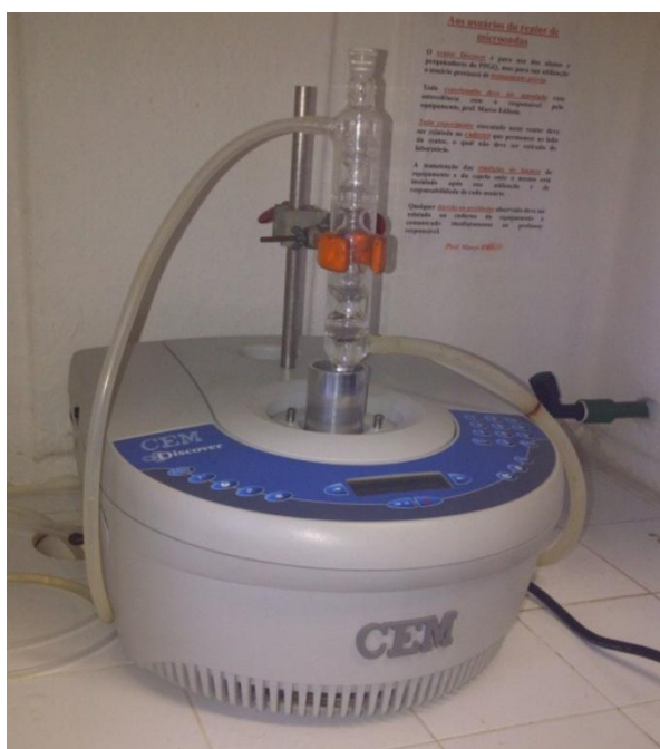
Figura 20. Aparelho de micro-ondas CEM Discover System , utilizado nas sínteses descritas neste trabalho.
