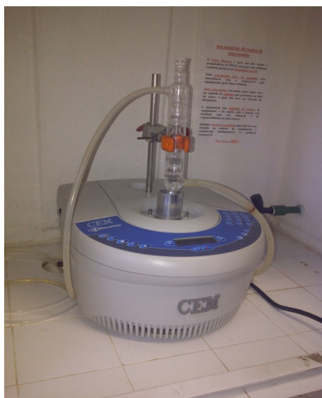
Figura 24: Reator de microondas utilizado para síntese orgânica em laboratório.
