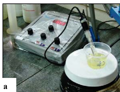
Figura 4. Determinação do pH do albúmen (a) e da gema (b) com peogômetro Mettler Toledo modelo 320.
