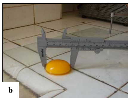
Figura 3. Determinação da altura da gema com micrômetro tripé Ames modelo S-6428 (a) e do diâmetro da gema com paquímetro analógico Mytutoyo (b).
