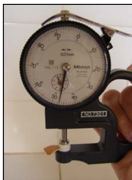
Figura 4. Determinação da espessura da casca com micrômetro analógico de pressão Mytutoyo.
