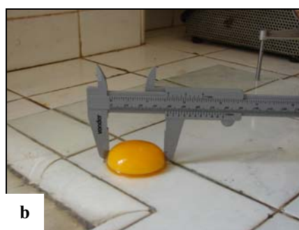
Figura 3. Determinação da altura da gema (a) com micrômetro tripé Ames modelo S-6428 e diâmetro (b) da gema com paquímetro analógico Mytutoyo.
