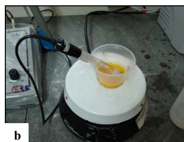
Figura 4. Determinação do pH do albúmen (a) e da gema (b) com peogômetro Mettler Toledo modelo 320.
