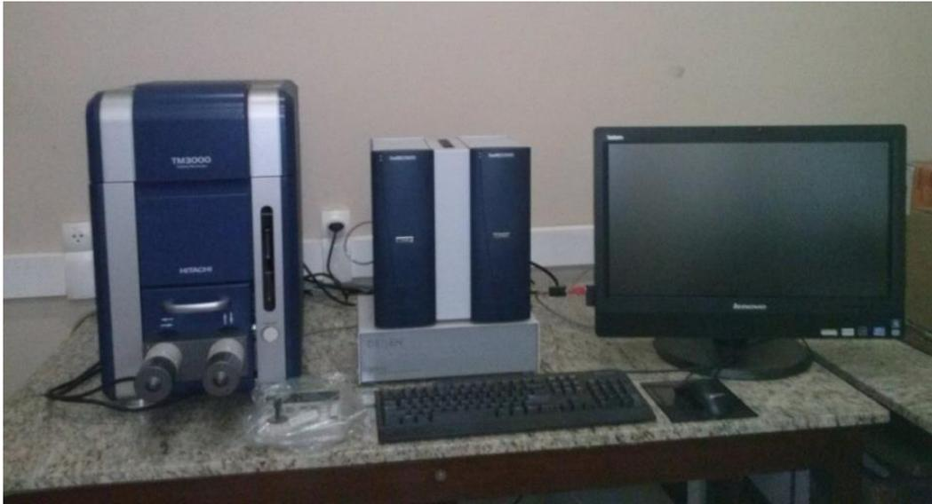
**Figura 24.** Microscópio eletrônico de varredura marca e modelo HITACHI TM-3000 com EDS OXFORD SWIFT ED (LMDS/UFRRJ), para análises das características da fibra fina e do pelo-guarda.
