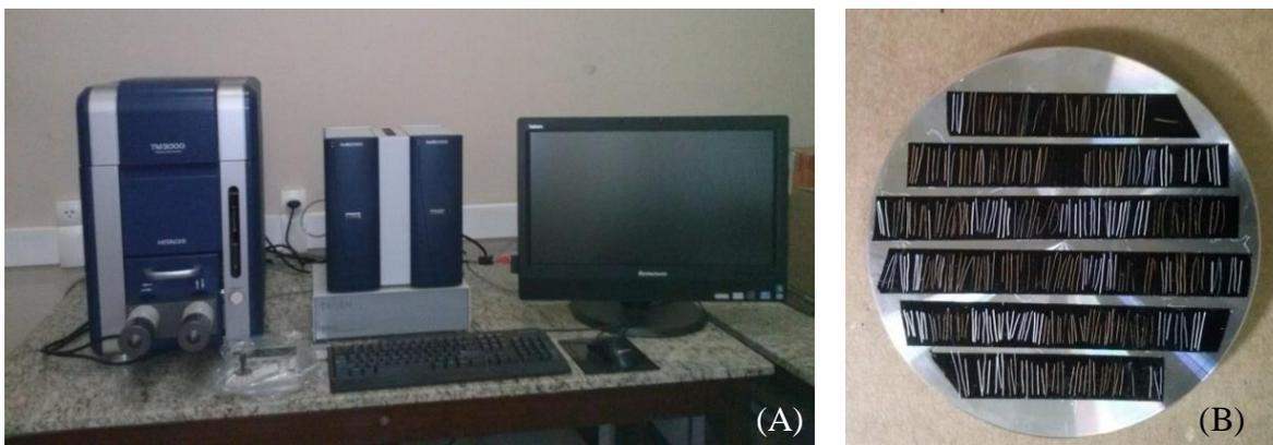
**Figura 19.** MEV- HITACHI TM-3000 com EDS OXFORD SWIFT ED (LMDS/UFRRJ) (A) e *Stub* com amostras de pelo-guarda colocados sobre fita de carbono (B), para análises das características do pelo.
