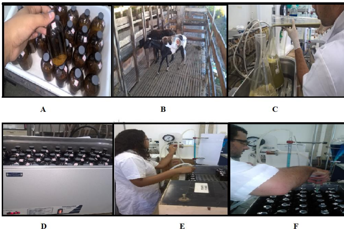
Figura 3. Frascos de cor âmbar cotendo as amostras (A), ovinos fistulados no rumem (B), meio de cultura e inoculo ruminal (C), amostras no banho maria (D), medições de pressão e volume (E e F).
