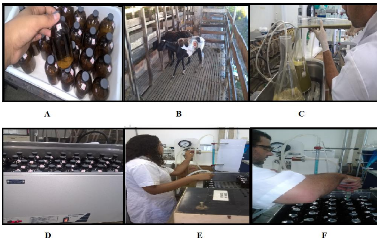
Figura 3. Frascos de cor âmbar cotendo as amostras (A), ovinos fistulados no rumem (B), meio de cultura e inoculo ruminal (C), amostras no banho maria (D), medições de pressão e volume (E e F).
