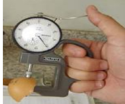
Figura 10. Micrômetro de pressão medindo espessura da casca (mm)
