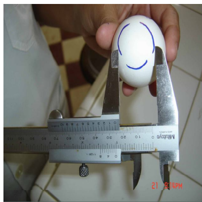
Figura 4. Paquímetro medindo o diâmetro da câmara de ar
