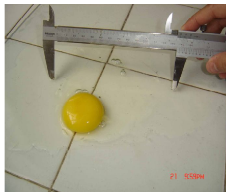
Figura 8. Medida do diâmetro do albúmem (mm) com paquímetro
