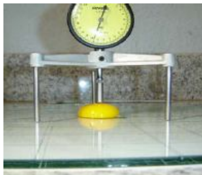
Figura 5. Medida da altura da gema (mm) com micrômetro
