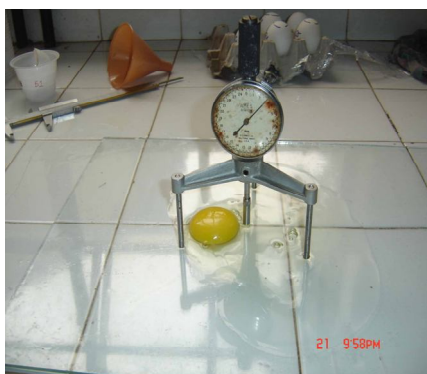
Figura 7. Medida da altura do albúmem (mm) com micrômetro
