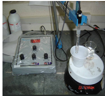
Figura 12. pHmetro medindo pH do albúmem
