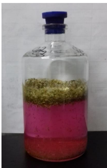
Figura 1. Frasco de fermentação com substrato hidratado imediatamente antes da inoculação. (Fonte: Acervo pessoal)
