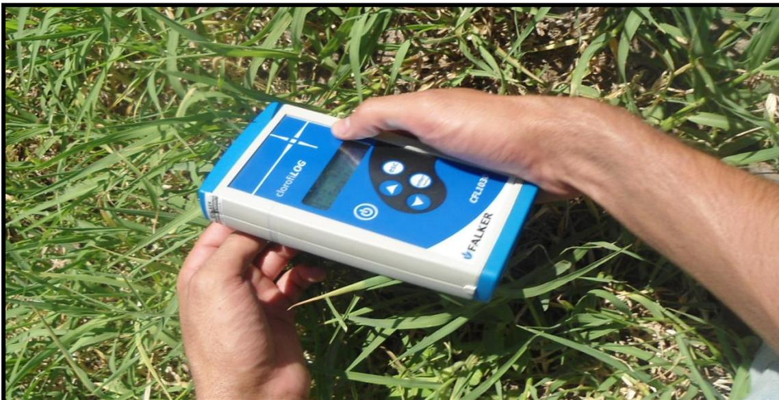
**Figura 7** – Avaliação no campo com o aparelho ClorofiLOG<sup>®</sup>-CFL 1030.
