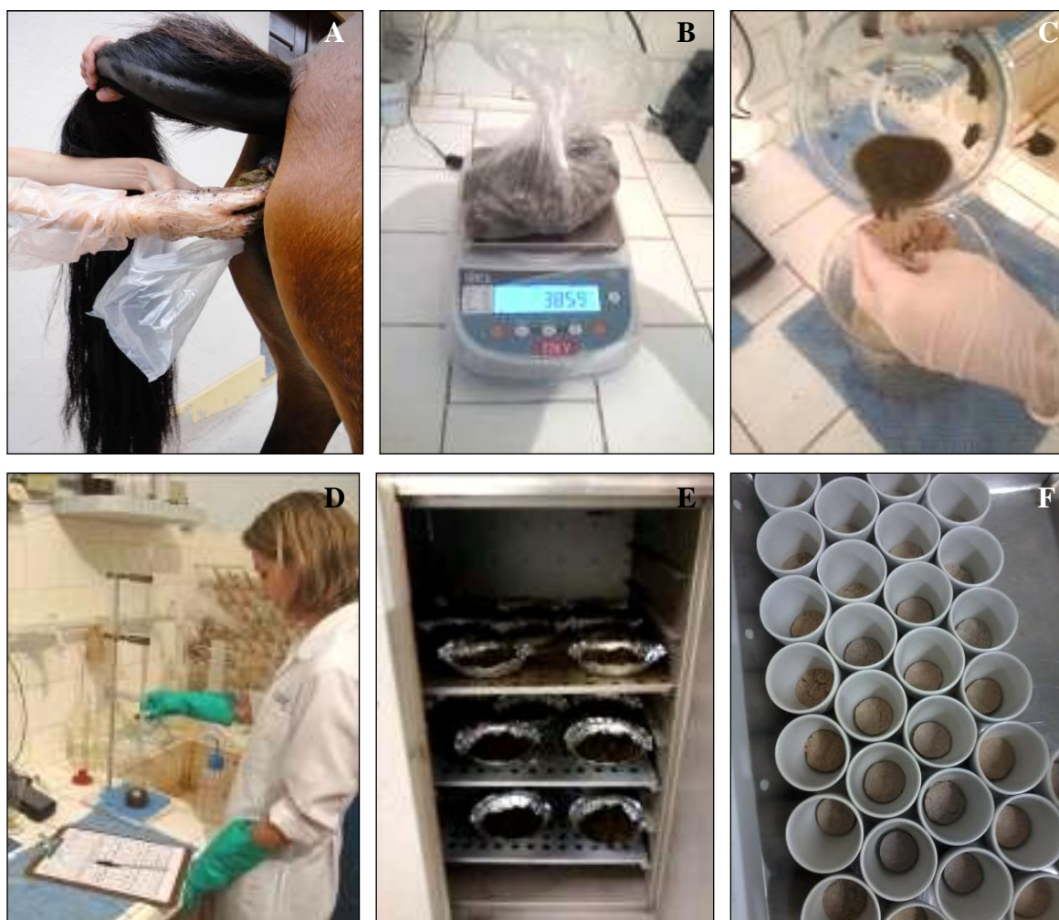
Figura 4. Coleta de fezes (A), pesagem da amostra (B), diluição das fezes para análise (C), avaliação da capacidade tampão (D), avaliação da matéria seca (E) e da mineral (F).
