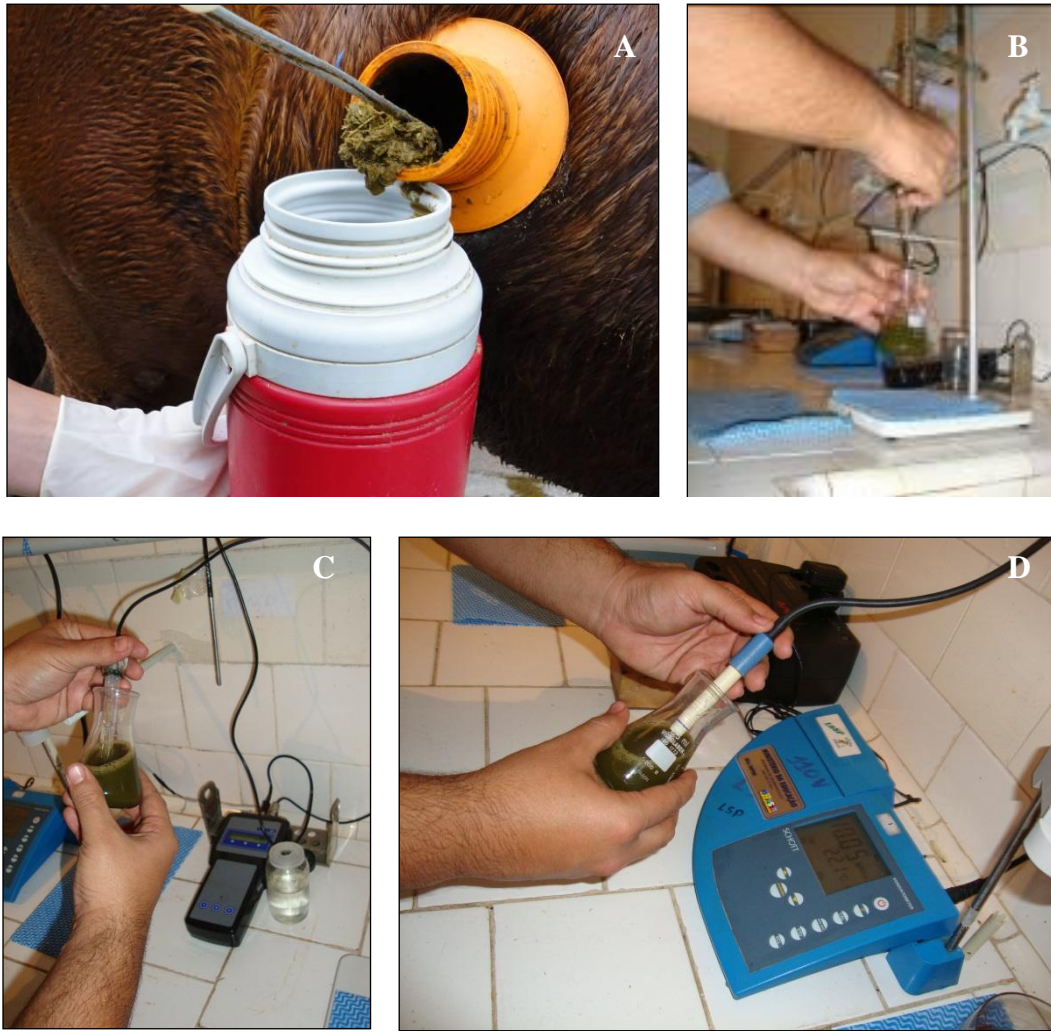
Figura 5. Coleta da digesta (A), avaliação da capacidade tampão (B), do pH (C) e da condutividade elétrica da digesta (D).
