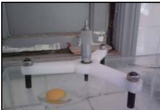
Figura 6 – Determinação da altura do albúmen denso com micrômetro tripé adaptado.
