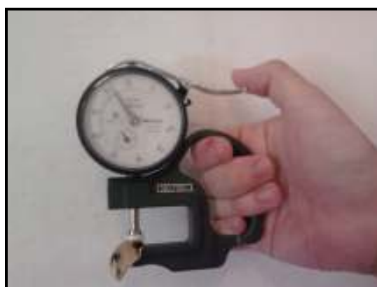
Figura 8 - Determinação da espessura da casca com auxílio do micrômetro analógico de pressão Mytutoyo.
