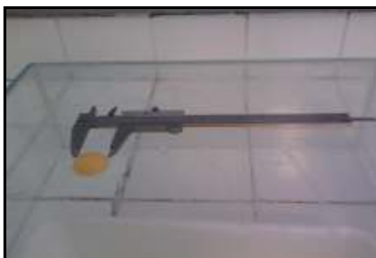
Figura 7 – Determinação do diâmetro da gema com paquímetro analógico Mytutoyo
