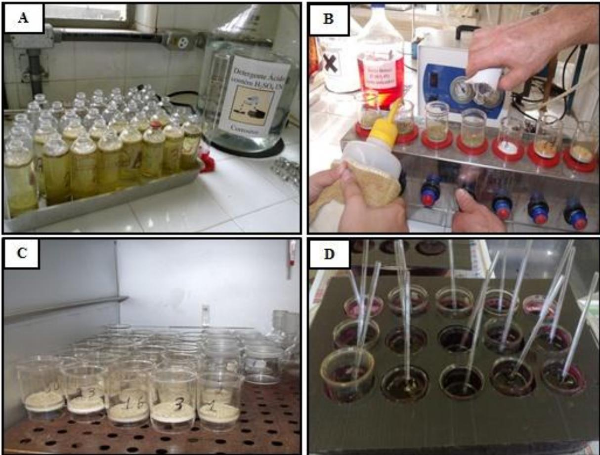
**Figura 37** Procedimentos utilizados para determinação dos compostos fibrosos: preparação das amostras com detergente em frascos de 100 ml (A), filtragem (B), secagem em estufa (C) e determinação de lignina com uso de permanganato de potássio (D).
