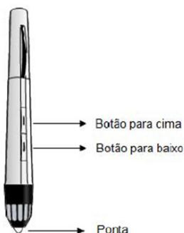
*A carga da caneta é feita por meio de uma porta USB do computador. São duas horas para obter uma carga completa que dá uma autonomia para uso de até 18 horas de uso contínuo. Por segurança, a caneta digital desliga-se automaticamente após sessenta segundos sem uso.*
