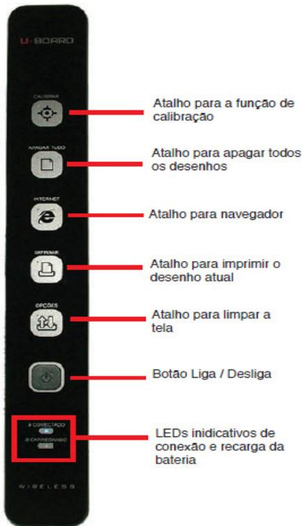
Além dos botões de atalho, na parte frontal do receptor Station existem duas luzes do tipo LED. Uma azul, que indica que o produto está conectado ao computador interativo e outra vermelha que indica que a bateria interna do receptor está sendo carregada.
