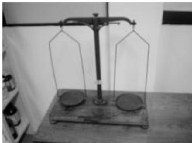
Figura 4.5: Representação da balança de dois braços (AFONSO & SILVA, 2004).
