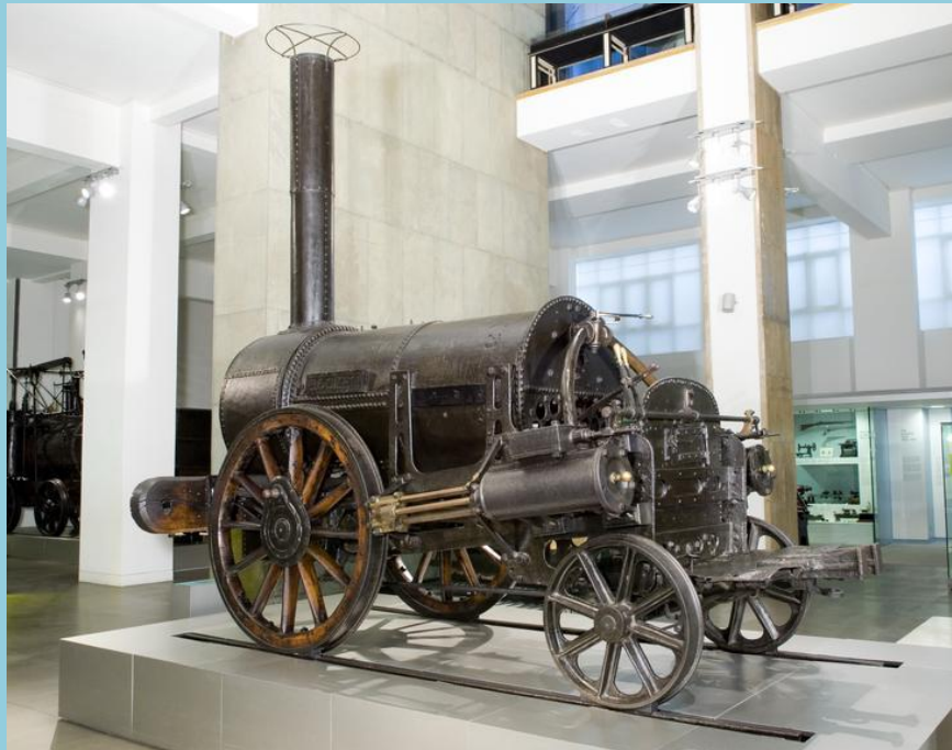
Figura 15 - Locomotiva 'Rocket', projetada por Robert Stephenson e produzida por Robert Stephenson & Co., em 1829. Foi a vencedora nas provas de locomotivas realizadas em Rainhill, em 1829, para decidir a força motriz da Ferrovia Liverpool & Manchester. Chegou a atingir a velocidade de 30 milhas por hora (aproximadamente 48 km/h).
