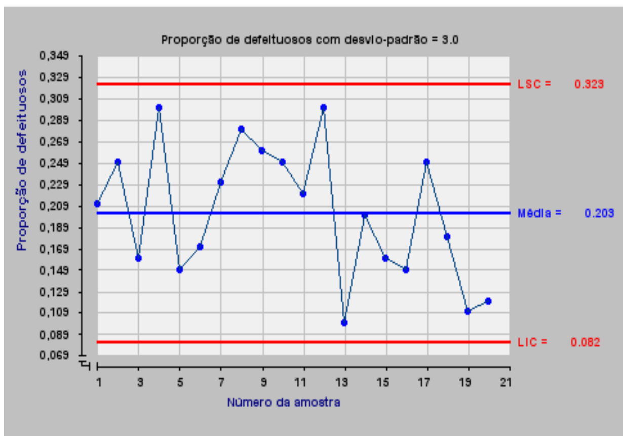
Figura 12 – Exemplo de gráfico de controle de defeitos em uma quantidade de amostras de produto.
