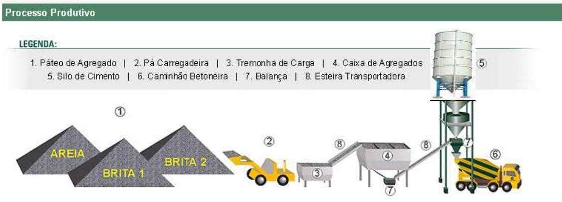
**Figura 3** – O processo produtivo do concreto dosado em central.
