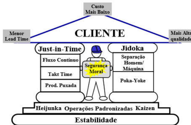
Figura 4 – Estrutura do Sistema Toyota de Produção.
