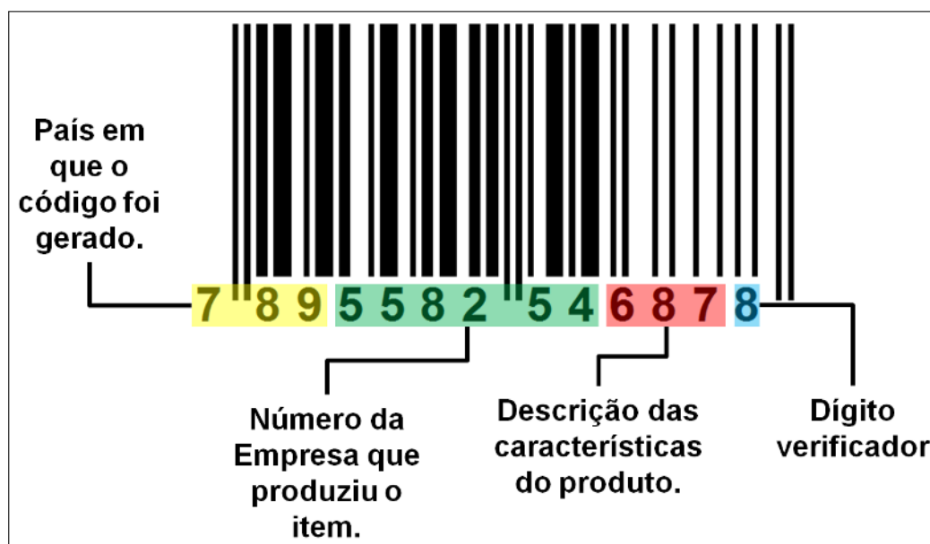
Figura 9 – Estrutura dos códigos de barras EAN-13
