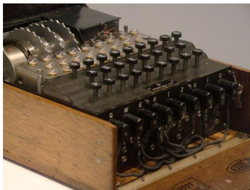
Figura 11 - A máquina Enigma.
