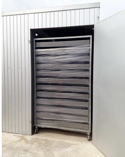
Figura 7. Estufa movida a energia solar para desidratação das sementes.
