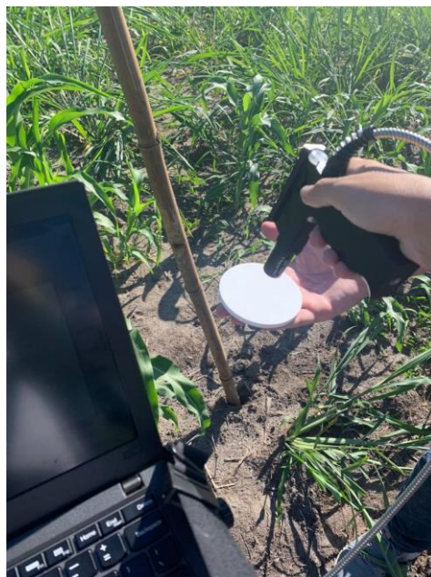
Figura 4. Leitura da placa Spectralon
