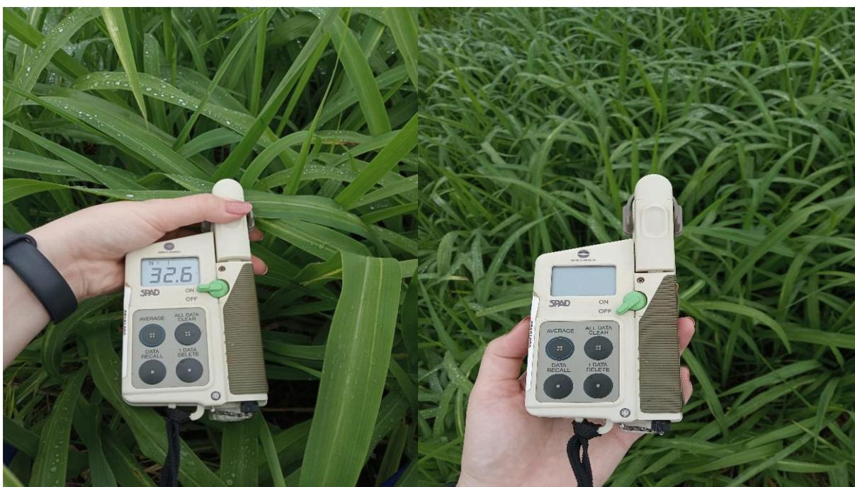
**Figura 8.** Avaliação da intensidade do verde das folhas utilizando-se o Clorofilômetro SPAD. Fonte: Arquivo pessoal.
