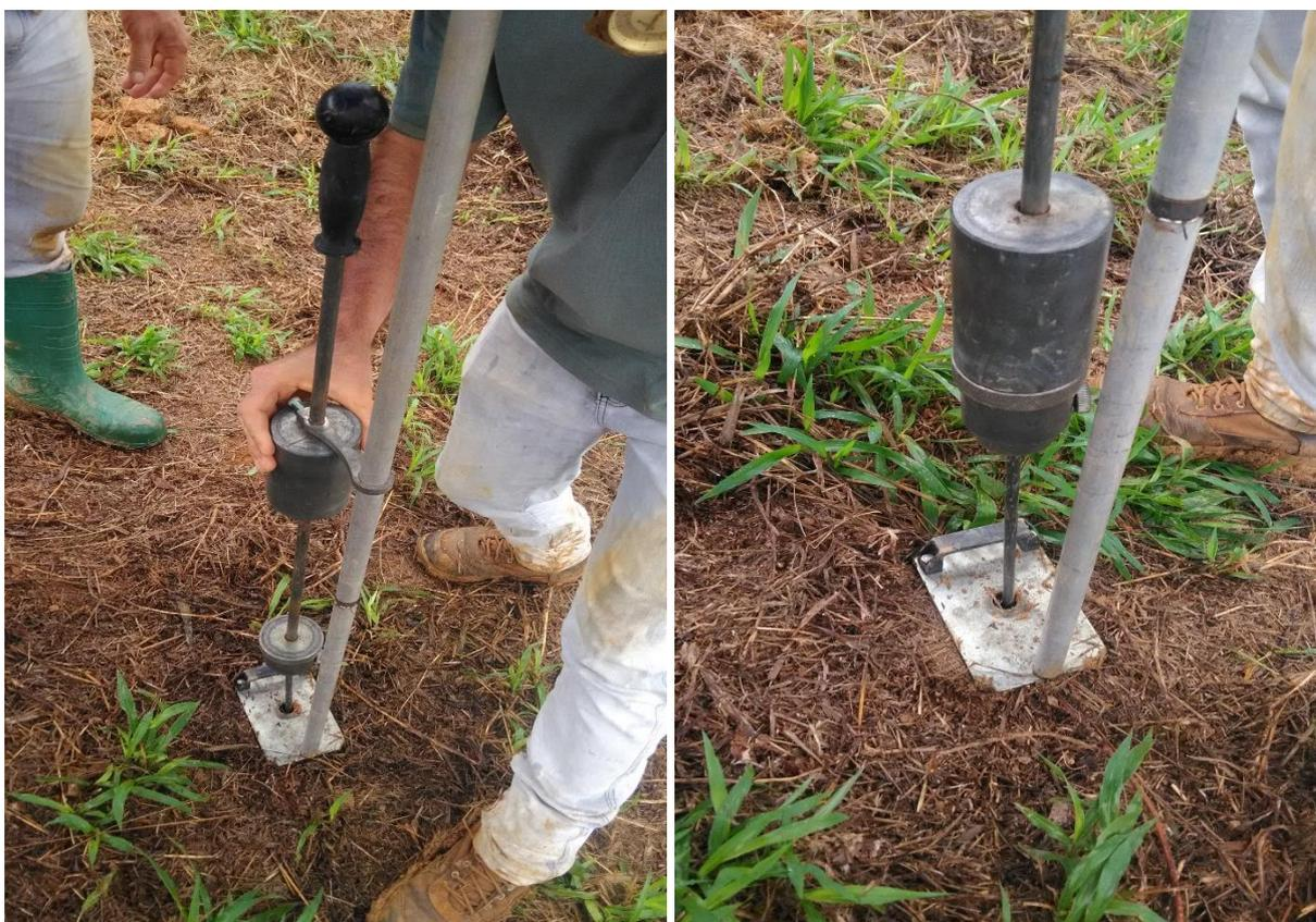
**Figura 4.** Avaliação da resistência do solo à penetração (RSP) utilizando-se o penetrômetro de impacto, em março de 2019. Fonte: Arquivo pessoal.
