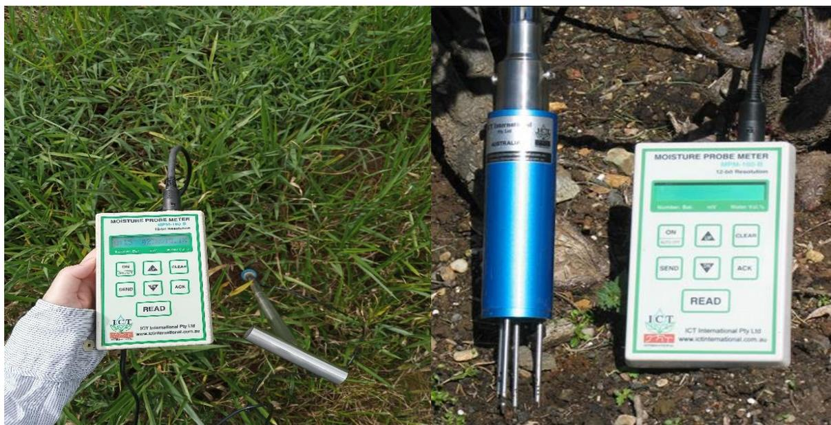
**Figura 6.** Avaliação do teor volumétrico de água no solo com a sonda medidora de umidade (MPM160B). Fonte: Arquivo pessoal e ICT INTERNATIONAL, 2017.
