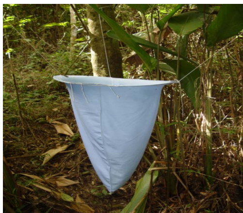
Figura 4: Coletor empregado na amostragem da deposição de serrapilheira em fragmentos florestais inseridos na Bacia do Rio Preto em Teresópolis, RJ.
