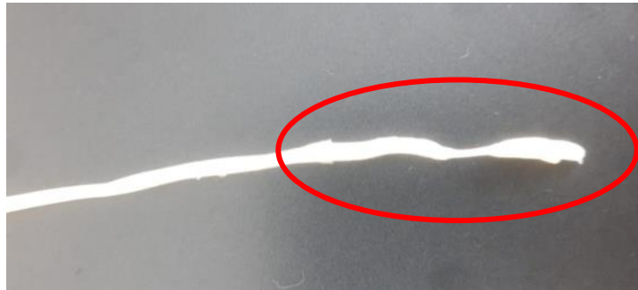
Figura 41: Deformação causada pelas engrenagens de tração da impressora 3D.
