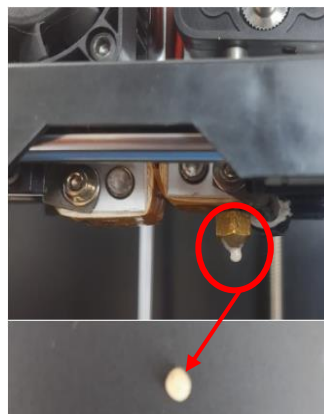
Figura 42: Formação de esfera no bocal de deposição da impressora.
