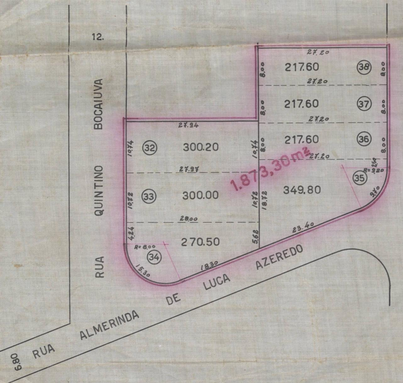
PLANTA DE DESMEMBRAMENTO DA AREA COM 1.873,30m<sup>2</sup>
