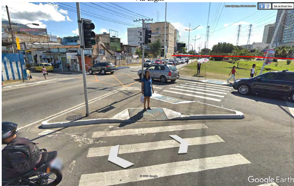
Figura 38 – Ilha de travessia com rampa de acesso para cadeirantes (sem piso tátil) - Centro, Via Light
