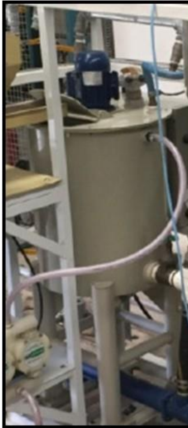
Figura 3.10: Tanque de mistura. Fonte: RACHID(2018).
