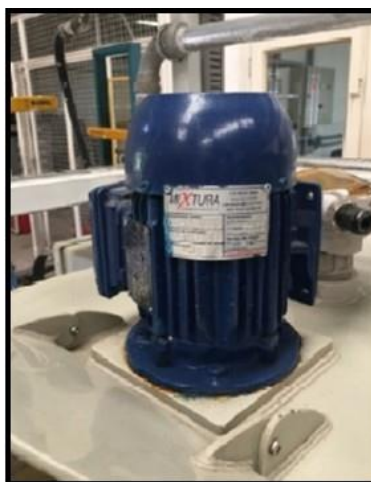
Figura 3.11: Agitador acoplado ao tanque de mistura. Fonte: RACHID(2018).
