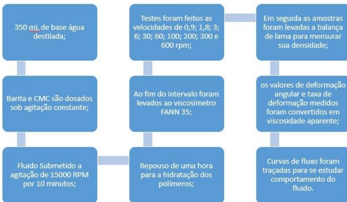
Figura 3.30: Procedimento experimental para os testes de bancada de interação entre barita e CMC Fonte: Própria.
