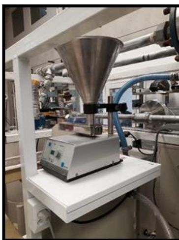
Figura 3.15: dosador de sólidos Retsch GmbH Tipo DR100 / 75 de acionamento digital Fonte: Própria.
