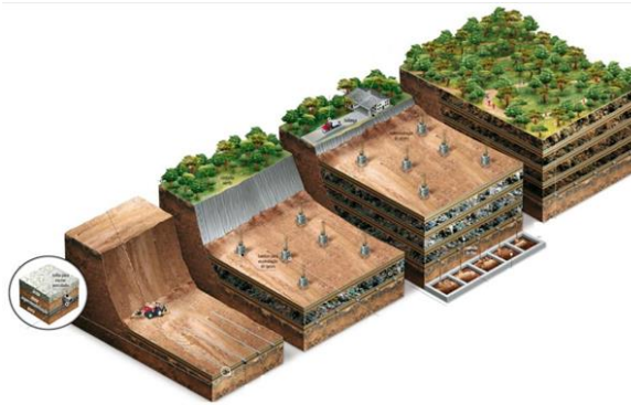
Figura 3: Aterro do tipo área. Fonte: SEDAM / RO, 2019.
