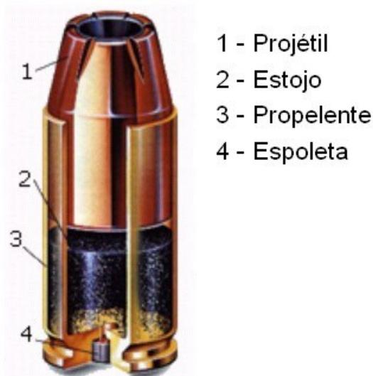
**Figura 1.** Ilustração dos componentes de um cartucho de munição. **Fonte.** Câmara, 2014.
