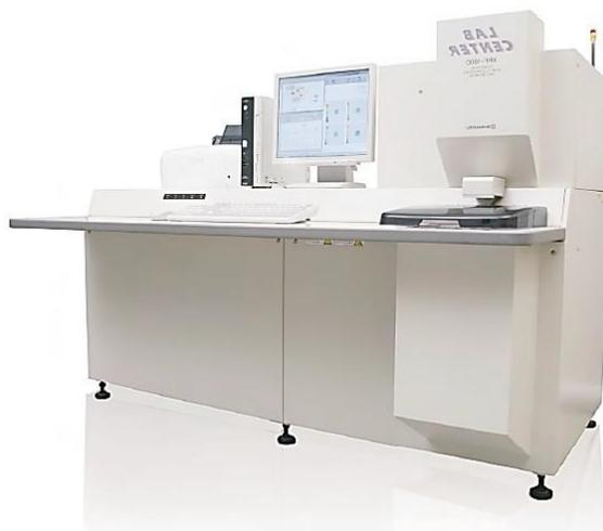
**Figura 17.** Equipamento WDXRF-1800 sequencial usado nas análises. **Fonte.** SHIMADZU CORPORATION, 2017.
