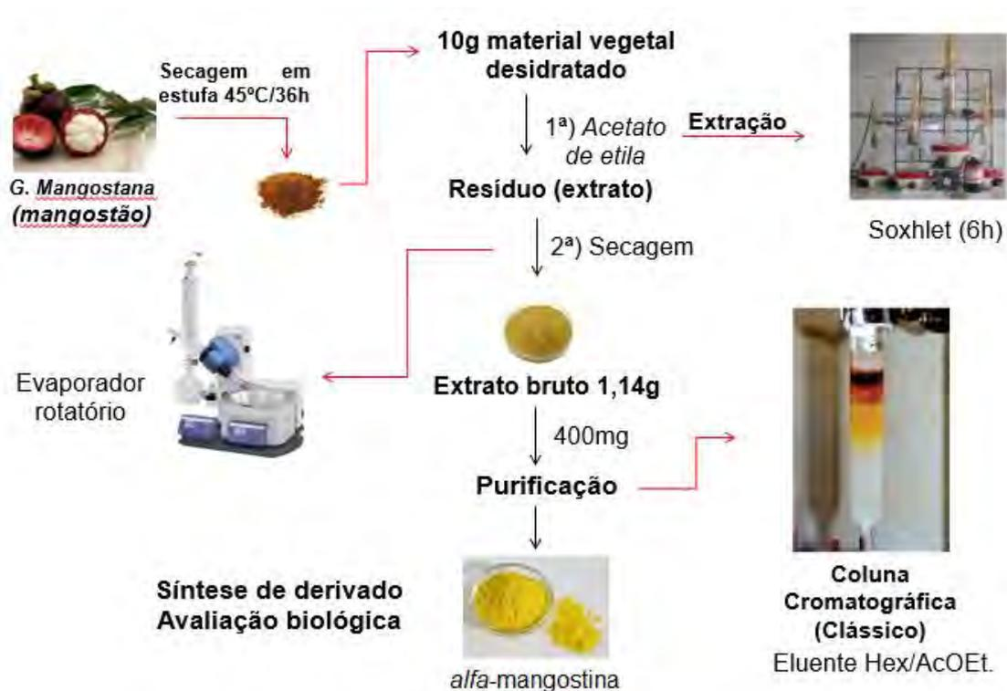
**Figura 22.** Método clássico de purificação de  $\alpha$ -mangostina.
