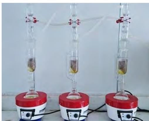
**Figura 17.** Aparelhagem de Soxhlet.
