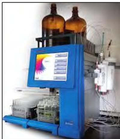
**Figura 19.** Equipamento Isolera, ACI – *Accelerated Chromatographic Isolation*.
