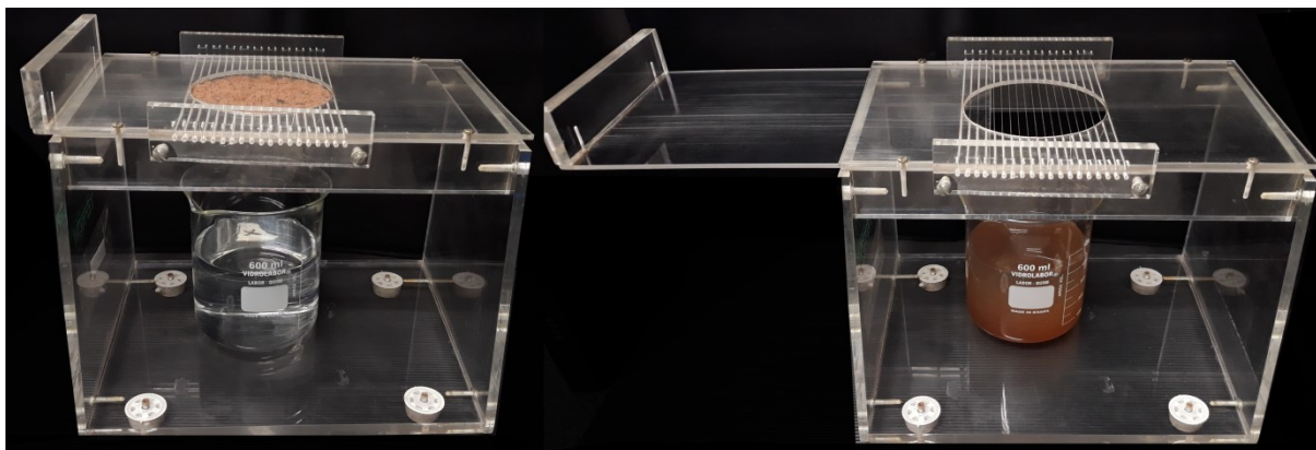
Figura 2 – Objeto de acrílico utilizado para análise de molhabilidade.
