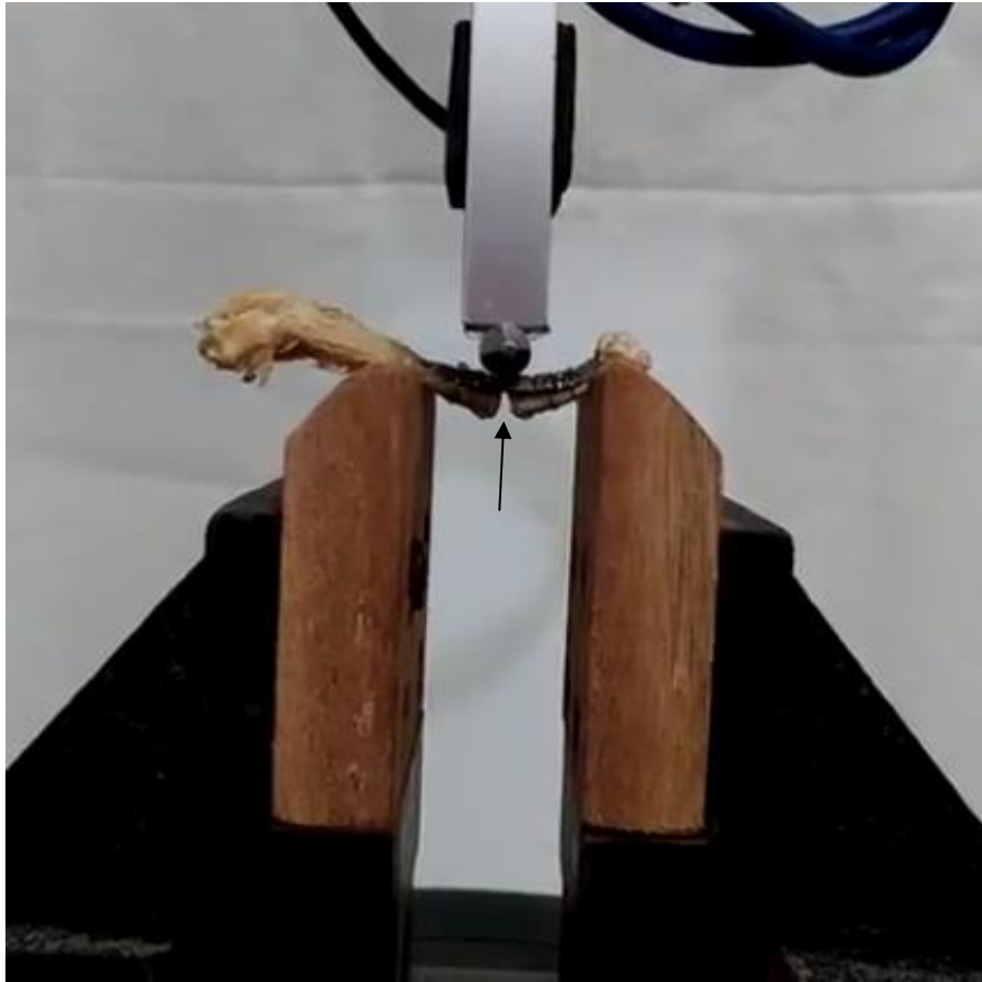
Figura 30: Falha óssea após ensaio de flexão em três pontos no conjunto osso, placa e fio de aço de cadáver formolizado de gavião-carijó ( Rupornis magnirostris ).
