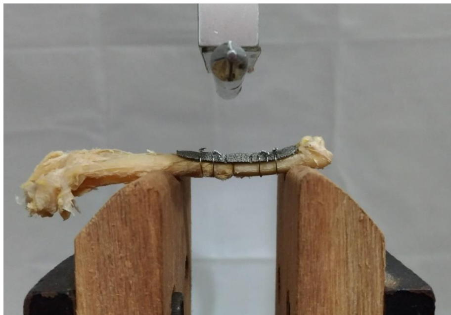
Figura 23: Ensaio de flexão em três pontos no conjunto osso, placa e cerclagem em úmero de cadáver formolizado de gavião-carijó ( Rupornis magnirostris ).
