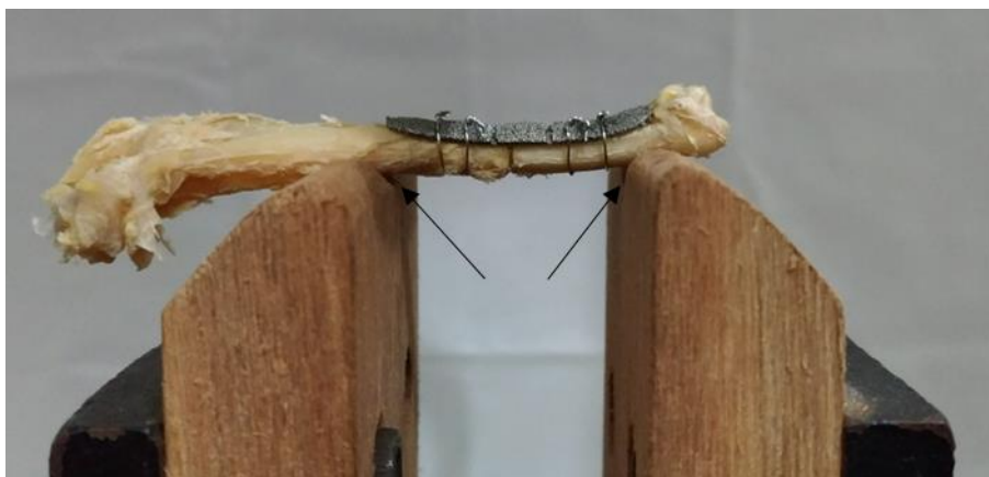
Figura 19: Suporte fabricado em madeira apresentando sulco para ajuste do úmero de cadáver formolizado de gavião-carijó ( Rupornis magnirostris ) para ensaio mecânico de flexão em três pontos.
