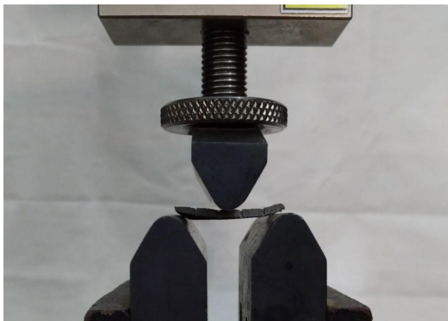
Figura 24: Ensaio de flexão em três pontos na placa ortopédica impressa em liga de titânio para correção de fraturas médio distais de úmero de gavião-carijó ( Rupornis magnirostris ).
