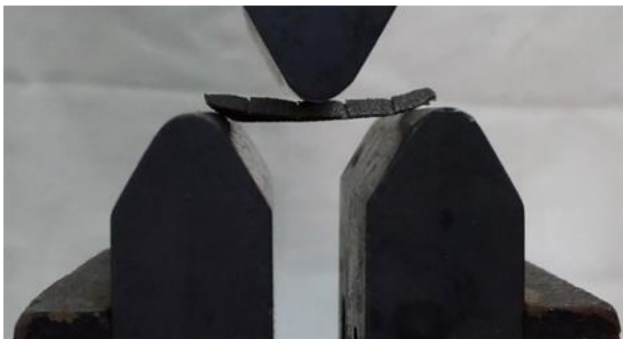
Figura 20: Ensaio mecânico de flexão em três pontos de placa metálica ortopédica customizada para úmero de cadáver formolizado de gavião-carijó ( Rupornis magnirostris ), com suporte original da máquina.
