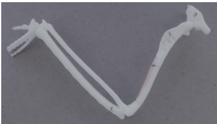
Figura 2: Vista lateral da asa de gavião-carijó impressa em resina poliamida para estudo anatômico.
