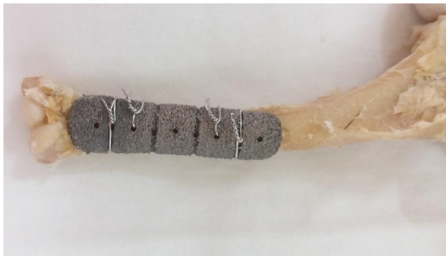
Figura 17: Osso dissecado da asa de cadáver formolizado de gavião-carijó ( Rupornis magnirostris ) após fixação da placa metálica para avaliação do ajuste placa-osso e utilização em ensaio de flexão em três pontos.
