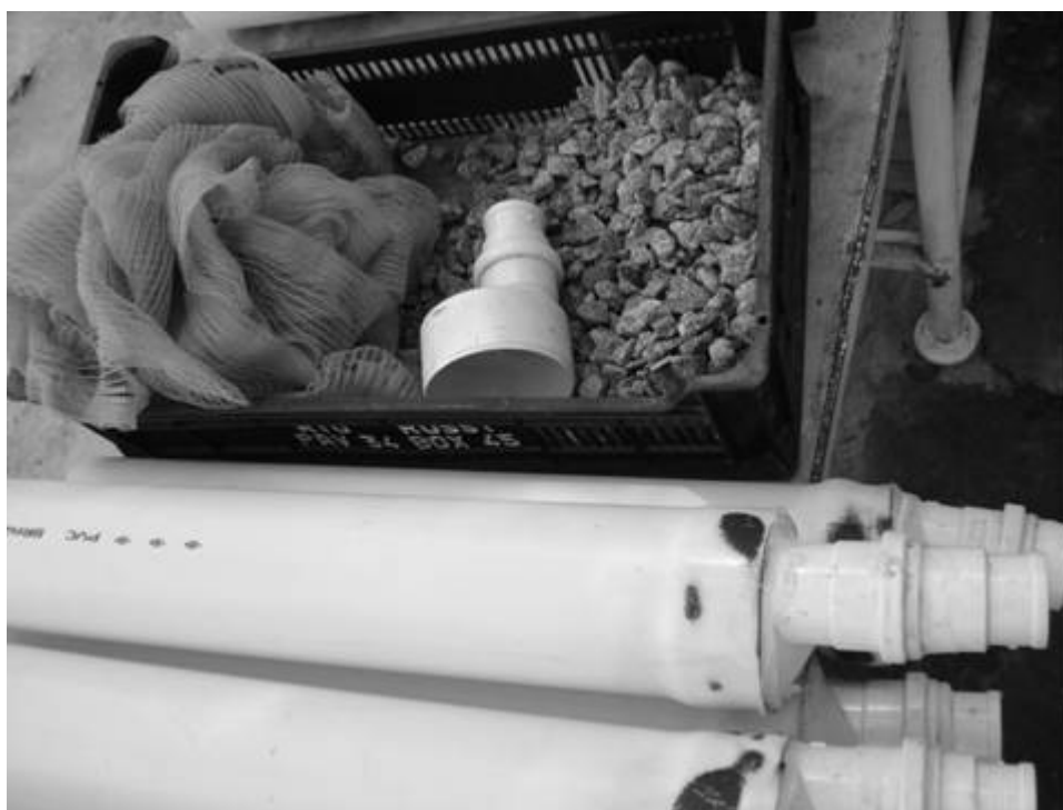
Figura 4. Montagem da unidade experimental (tubo de PVC, reduções, brita e tela de nylon).
