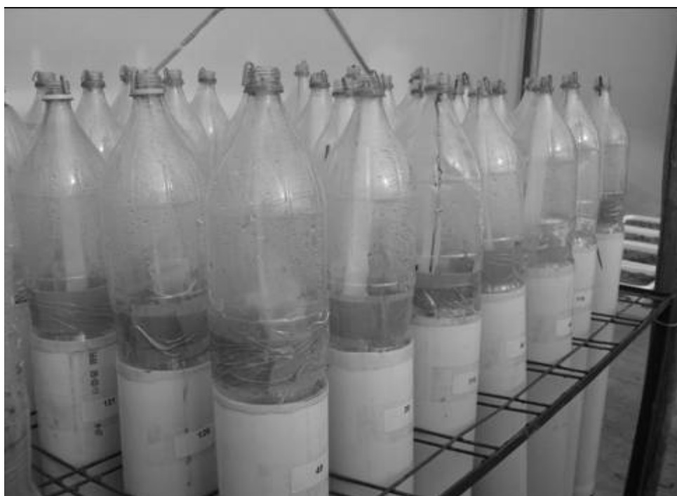
Figura 7. Câmara coletora de amônia encaixada em unidades experimentais.
