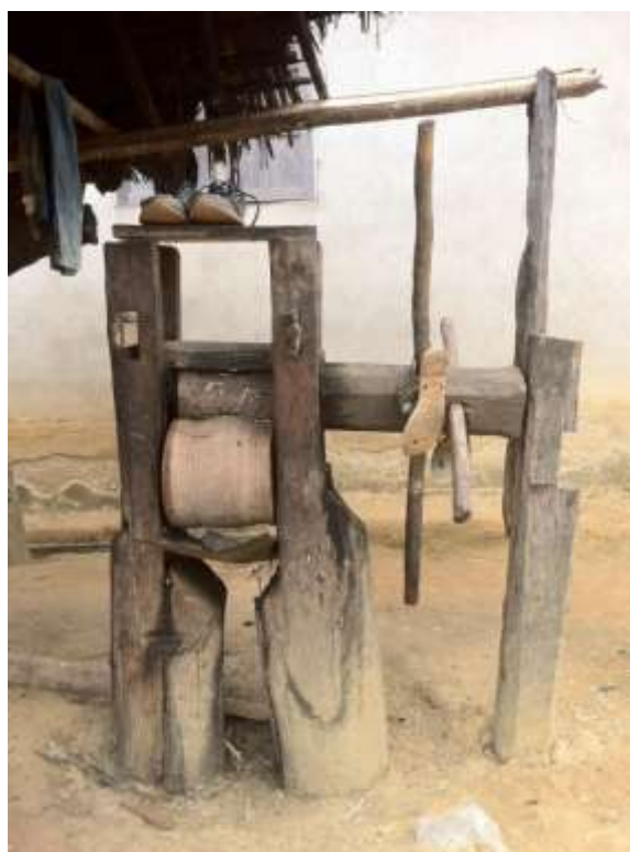
Figura 16 - Engenhoca utilizada para a extração da garapa da cana para a produção de melado. Fonte: Trabalho de cana, Fev/2014.
