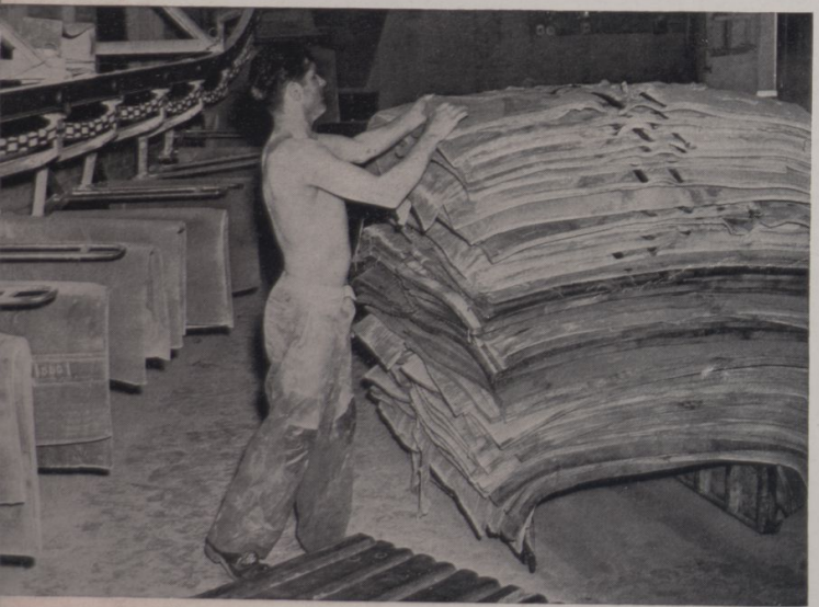
3 Fólhas de borracha emergem na fábrica de reconstrução do produto. Podem ser agora usadas na maioria de aplicações em equipamento de guerra, como se fôra borracha nova
