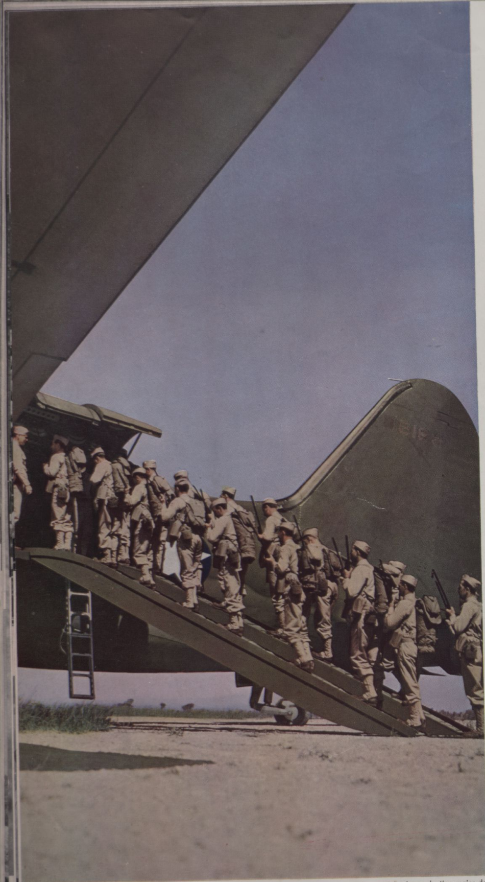
Tropas de infantaria, especialmente treinadas, embarcam num dos novos e enormes transportes aéreos, do tipo maior do mundo. Estes aviões têm capacidade para 25 toneladas de carga e dispõem de dois potentes motores de 2.000 cavalos
