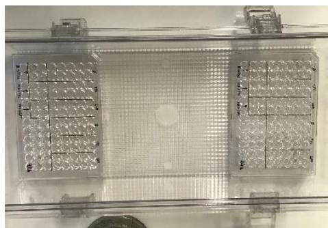
Figura 6. Jarra para incubação das microplacas de 96 poços, em atmosfera de microaerofilia. Fonte: LABZOO/CCAMP.
