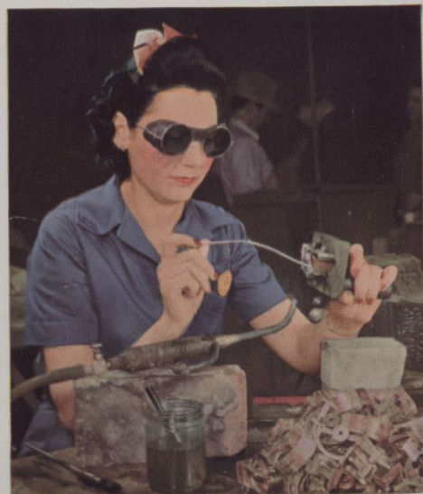
Soldar o mostrador do depósito de gasolina de um avião requer bastante habilidade. Mas esta operária, Nellow Robbins, é perita
