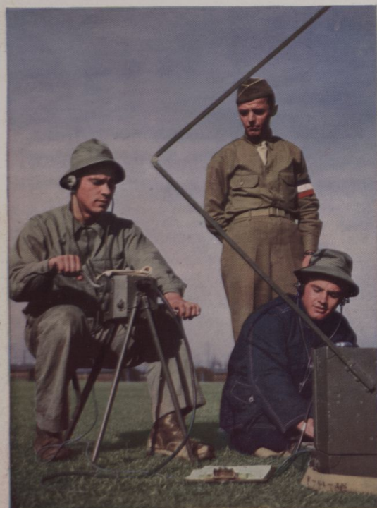
Por meio de um gerador manual, o soldado à esquerda fornece a energia necessária para fazer operar o seu indispensável rádio de campanha
