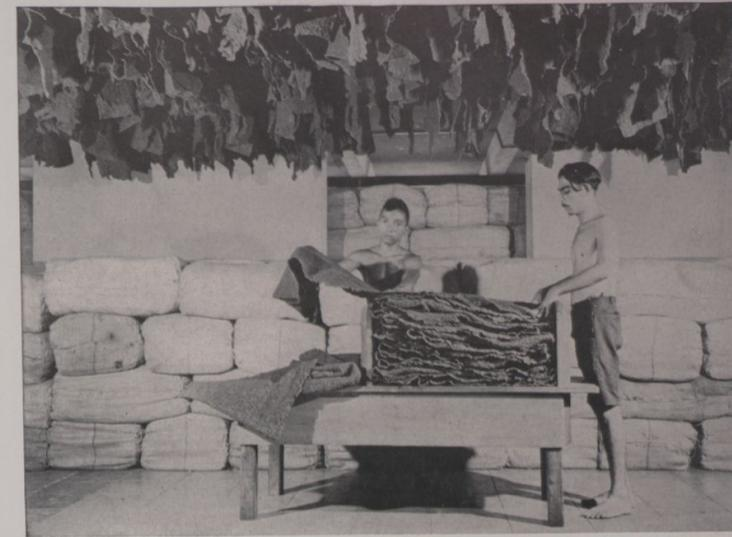
**O moderno método** de preparar a borracha, feita em fôlhas defumadas. Aqui as fôlhas são retiradas e dispostas em fardos de peso padronizado, prontos para serem transportados pelo próximo avião cargueiro
