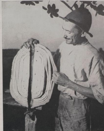
**Pelo antigo método,** uma bola de borracha é formada mergulhando-se um pau no látex. Aqui se vê um corte de uma bola
