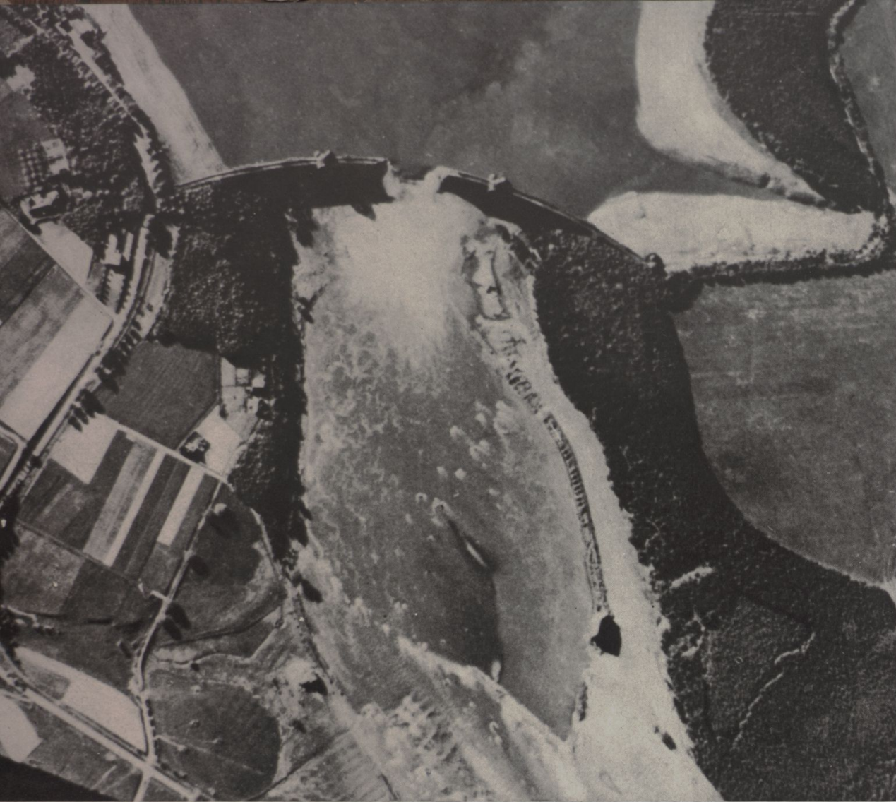
A represa de Moehne, na Alemanha, jorrando água, depois de ter sofrido um rombo de 61 metros, em consequência do bombardeio realizado pelos aviões aliados
