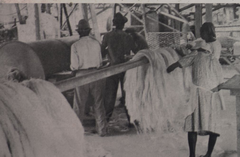
A fibra abacá sendo preparada para o mercado. Faz-se o corte de várias camadas da fibra, que é passada na máquina, para remover a matéria celular de pouca consistência. A fibra é depois secada (em baixo) em canos de ferro, ao ar livre. Depois de seca, é classificada e embalada, pronta para ser embarcada. A sua aplicação na fabricação de cordoalha vem substituir agora o produto que era cultivado antes nas ilhas Filipinas
