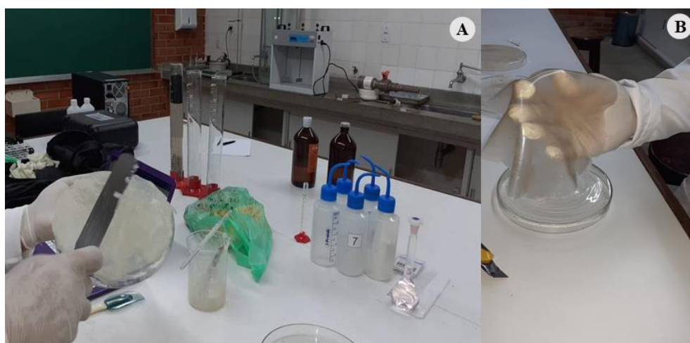
Figura 22. Obtenção de um filme polimérico. a) Procedimento para produção de filmes poliméricos; e b) filme polimérico. Fonte: Elaborado pelo autor, 2020.
