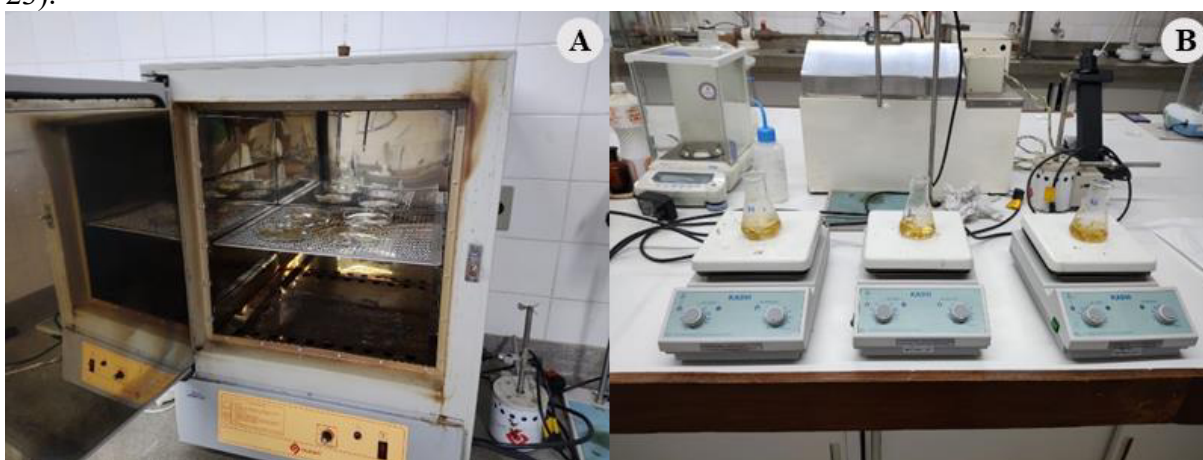
Figura 23. Ensaio de solubilidade. a) estufa; b) amostras em frasco erlenmeyer. Fonte: Elaborado pelo autor, 2021.
