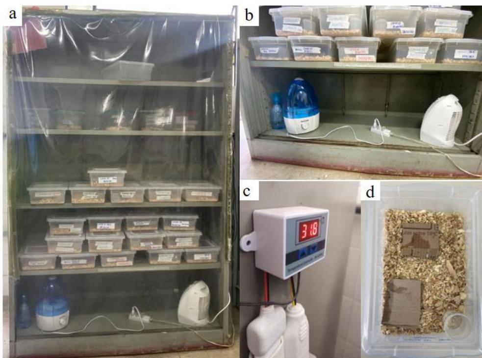
**Figura 14.** Armário modificado para uma câmara de crescimento visando a incubação das colônias de insetos em condições de temperatura e umidade controlados. (a) Armário modificado, (b) Umidificador e ventilador aquecedor que mantém a temperatura e a umidade ideal, (c) Controlador de temperatura e (d) Caixa onde os insetos ficam.
