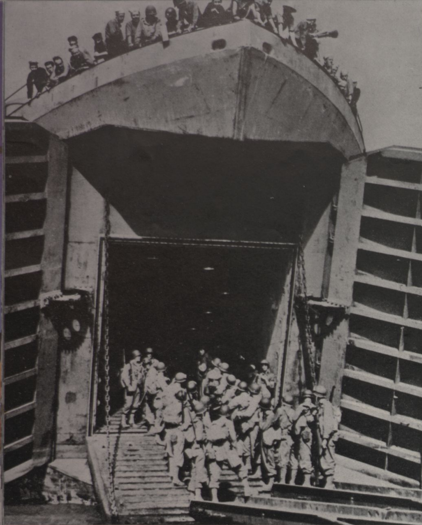
Transportes de tropas invasoras, como este, levam grandes quantidades de combatentes e de material bélico para os pontos de ataque. A prôa é dotada de enormes portas, por onde desembarcam rapidamente as forças atacantes. Em baixo: marinheiros americanos durante o ataque contra Paesternum, ao sul de Salerno, estiram-se na areia enquanto os bombardeiros nazistas atacam. Ao fundo: o efeito da explosão de uma bomba
