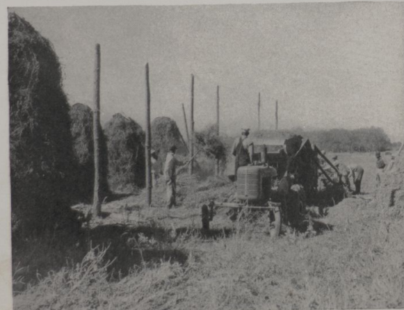
Conquanto a colheita do amendoim seja feita geralmente à mão, máquinas como a que se vê nesta gravura também são usadas. Servem para arrancar a planta inteira e para separar o amendoim da palha, a qual é então convenientemente enfardada
