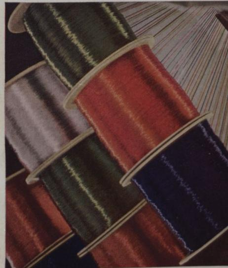
Fios de material plástico, que se podem fazer de várias cores. Com o mesmo material estão sendo fabricados cabos resistentes aos ácidos
