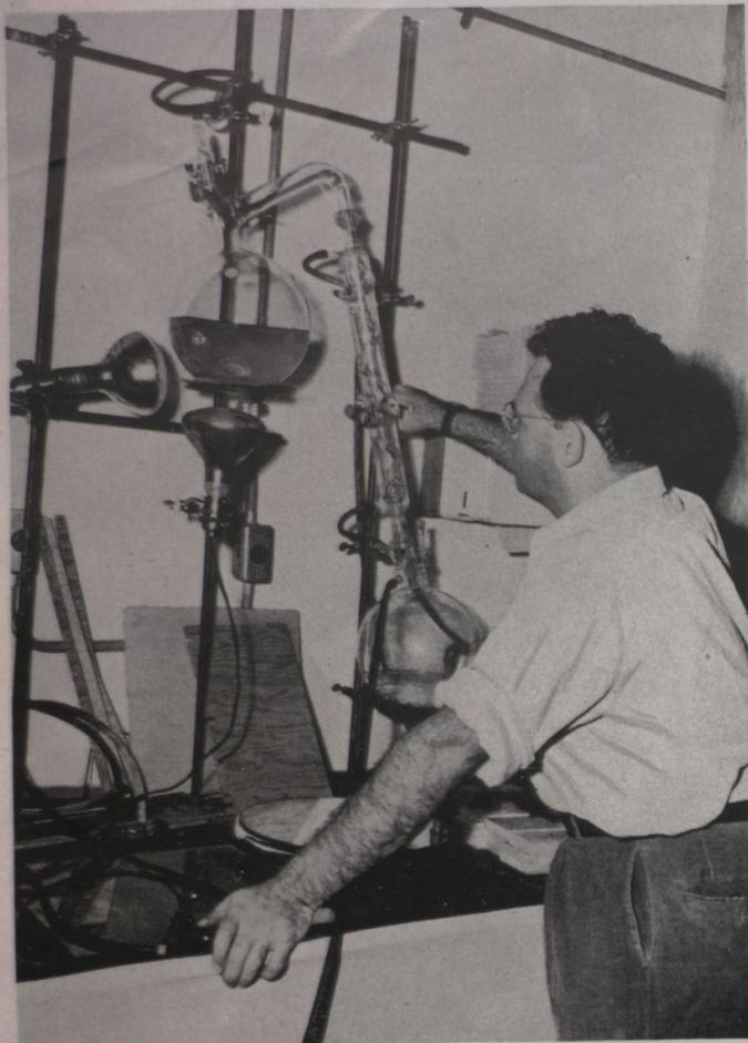
**Aparêlho** para destilar um material plástico especial usado para colar outros materiais plásticos. Certo tipo de madeira laminada ("plywood") é composto de trinta a cinquenta lâminas de madeira
