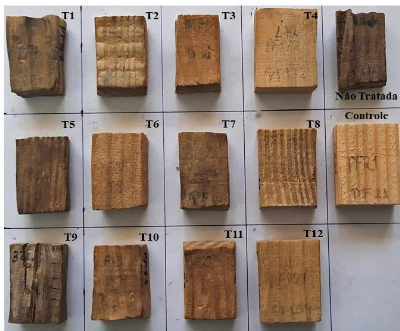
Figura 29. Efeito da degradação biológica causada pelo fungo Postia placenta nos diferentes tratamentos da madeira de pinus acetilada após 16 semanas de ataque.
