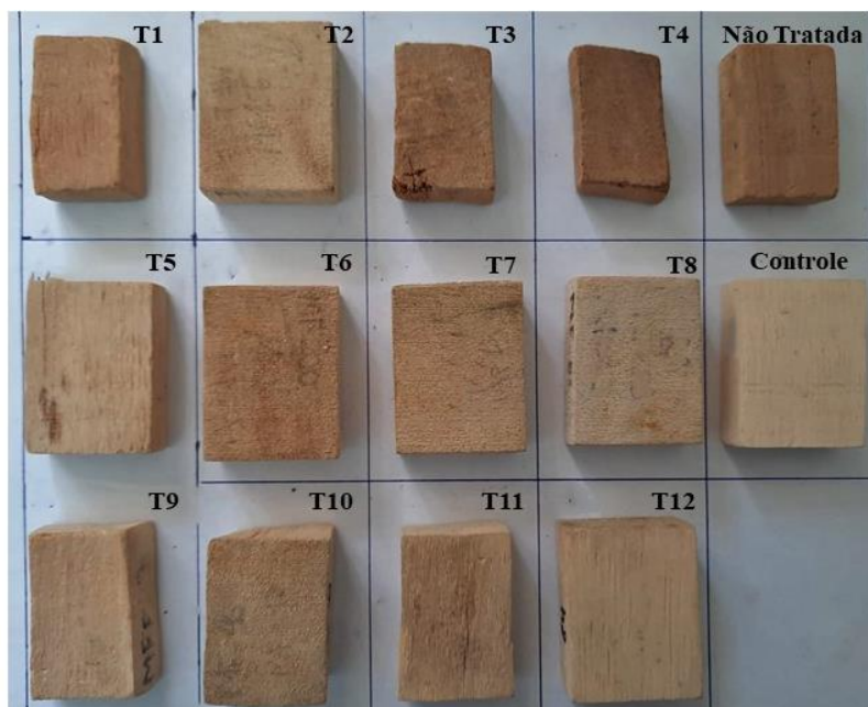
Figura 30. Efeito da degradação biológica causada pelo fungo Postia placenta nos diferentes tratamentos da madeira de marupá acetilada após 16 semanas de ataque.
