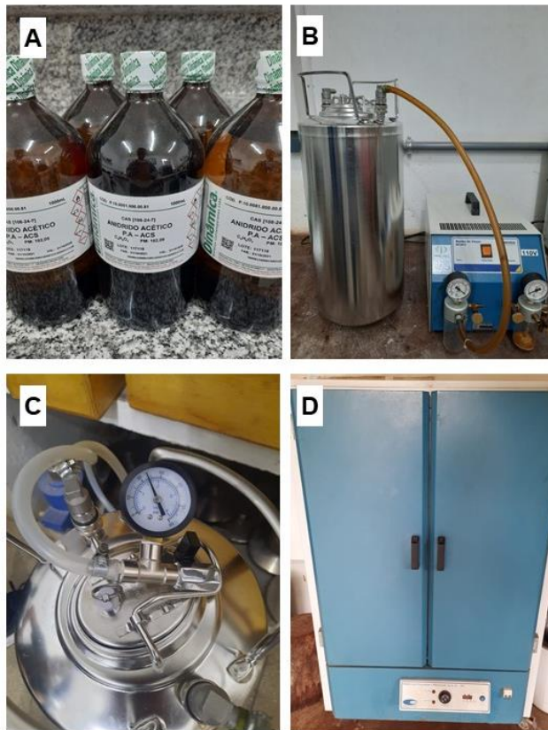
Figura 14. Etapas da metodologia de acetilação da madeira. A- Anidrido acético PA. B- Aplicação de vácuo em tanque de aço inoxidável para impregnação das amostras. C- Aplicação de pressão. D- Estufa de aquecimento.
